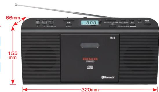
●サイズ:320(幅)×155(高さ)×66(奥行)mm ●質量:約1.3kg(乾電池含まず) ●CD(再生可能ディスク):CD、CD-R、CD-RW/チャンネル数:2チャンネルステレオ/サンプリング周波数:44.1kHz/リピート再生(1曲/全曲)/ランダム再生対応 ●ラジオ(方式):AM/FM(ワイドFM対応)/受信周波数:AM:522~1620kHz/FM:76~108MHz ●入出力端子:ヘッドホン出力端子 ステレオミニ(φ3.5mm)、AUX外部入力端子 ステレオミニ(φ3.5mm) ●電源:AC100V(50/60Hz)、DC9V 単2形乾電池x6個使用(乾電池別売) ●付属品:電源コード、取扱説明書、保証書
